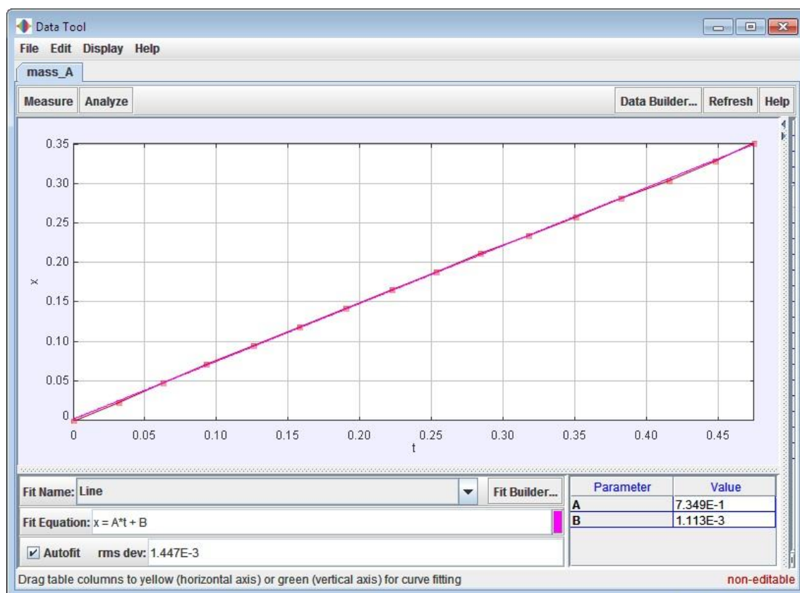
Gambar 5. Menu Data Tool pada Tracker dari sebuah benda yang bergerak linier pada bidang sepanjang 0,5 meter. Posisi benda tiap selang waktu ditunjukkan oleh titik-titik berwarna merah
